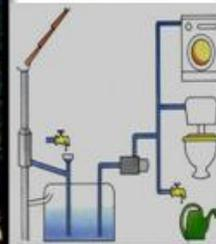
El agua pluvial almacenada en cisternas, se puede utilizar en los sanitarios, el riego de jardines, el mantenimiento y limpieza de las escuelas. Llegará el momento en el que las unidades habitacionales también tengan que captar el agua de lluvia, que tratada con filtros especiales, pueda ser usada como agua potable.
