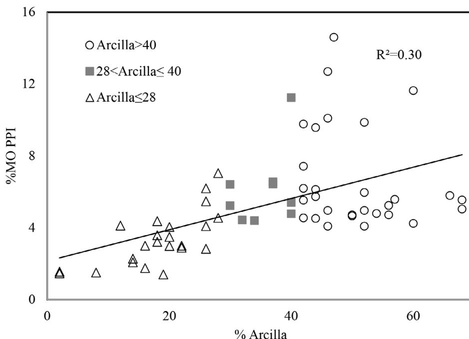
**Figura 2.** Comparación del contenido de MO (%) en suelos de Honduras determinado por el método pérdidas por ignición (PPI), tomando en cuenta el contenido de arcilla (%) en tres intervalos:  $\leq 28$ ,  $28 < \text{Arcilla} \leq 40$  y  $> 40$ .  $R^2$  representa el coeficiente de ajuste de tendencia lineal.
