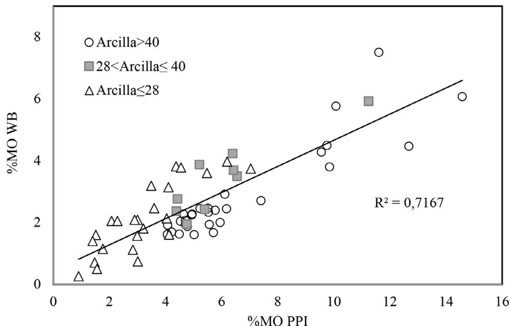
**Figura 1.** Comparación del contenido de MO (%) en suelos de Honduras determinado por el método *Walkley-Black* (WB) y por el método pérdidas por ignición (PPI).  $R^2$  representa el coeficiente de ajuste de tendencia lineal. Los datos de esta figura incluyen suelos con rango de contenido de arcillas desde 0 hasta 68 %.
