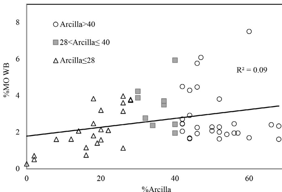
**Figura 3.** Comparación del contenido de MO (%) en suelos de Honduras determinado por el método de *Walkley-Black* (WB) tomando en cuenta el contenido de arcilla (%) en tres intervalos: ≤28, 28<Arcilla≤ 40 y 40. R<sup>2</sup> representa el coeficiente de ajuste de tendencia lineal.
