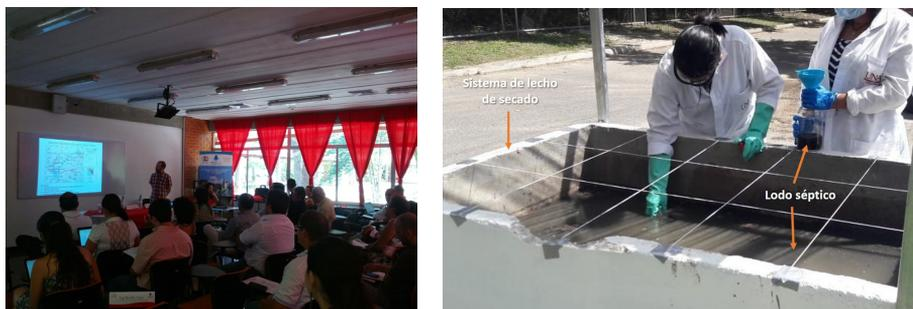
*Nota.* a) Capacitación a la comunidad en la temática de tratamiento de aguas residuales; b) colecta de muestras para caracterización microbiológica en lecho de secado de lodos sépticos. Fotografías propiedad de Hidrocec-UNA.
