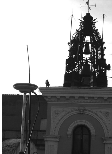
Figura 14. En primer término, la estación fija de referencia. Al fondo el campanario de la fachada principal del Ayuntamiento de Guadalajara
