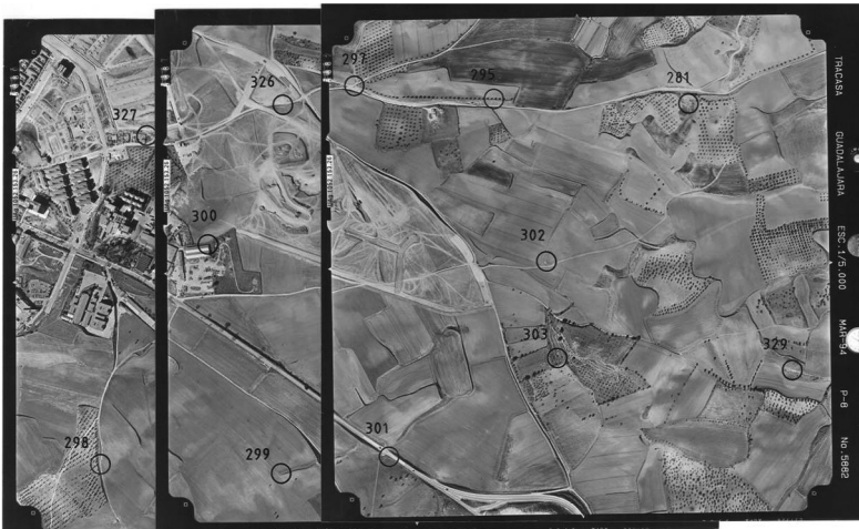
Figura 5. Modelos estereoscópicos de vuelo realizado en Guadalajara a escala 1/5000.
