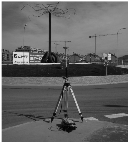
Figura 13. Receptor GPS estacionado sobre vértice ubicado en Glorieta de Alcorlo de Guadalajara.
