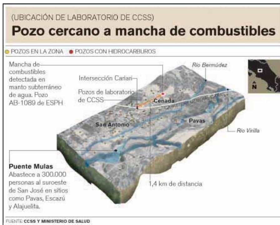
**Figura 11:** Esquema de la contaminación por hidrocarburos en los pozos del Laboratorio de Soluciones Parentales de la CCSS. Fuente: Periódico La Nación, 23 Noviembre de 2005.
